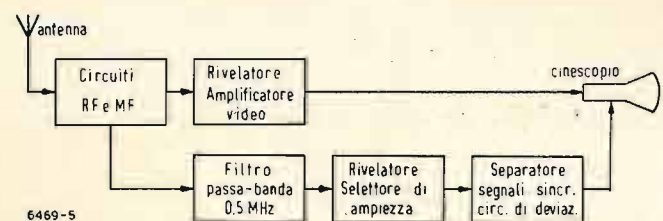
Fig. 5. — Schema a blocchi del ricevitore per modulazione intercalata a canale unico per segnali di sincronismo
